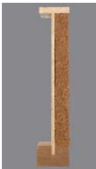
BE plus DP 60 s dřevovláknitou izolací.
