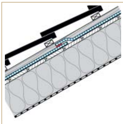
SOLITEX UD na záklopu. Lepené spoje pomocí DUPLEXu. U UD connect pomocí integrované lepicí pásky
