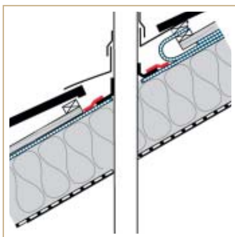
Napojení prostupu. Vytvořte žlábek z fólie
