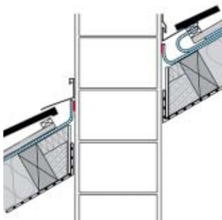
Napojení komína. Vytvořte žlábek z fólie
