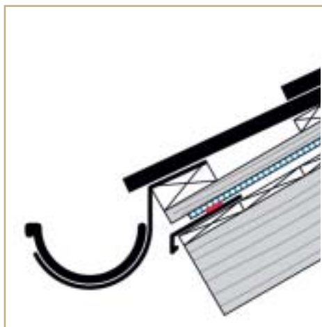
Pásky střešní izolace vyvedte na okapní plech a zalepte
